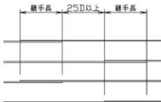
継手の相互位置 (25D以上のずれ)
