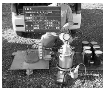
受入検査状況 (スランプ、空気量、塩化物イオン量等)
