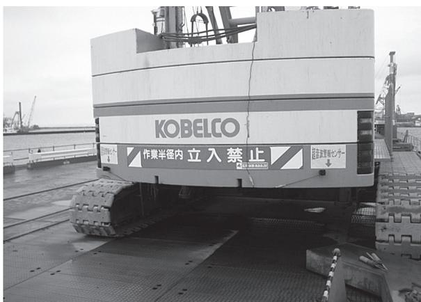
写真9 ● クレーン後方監視センサー取付状況
