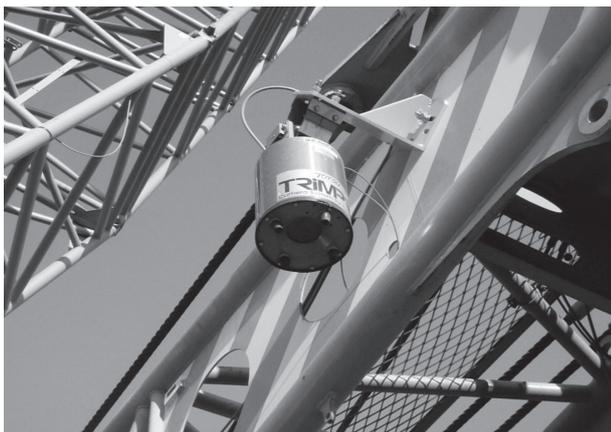
写真7 ● クレーンブーム先端に取付けた監視カメラ
