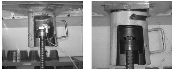
写真2 定着具の引張試験状況 (左:鉛直引張、右:勾配引張)
