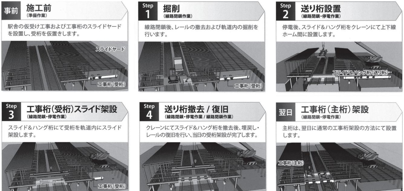
図-6 スライド&ハング工法施工ステップ図
