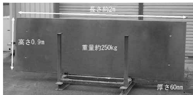
図-12 高強度繊維補強モルタル製の埋設型枠
