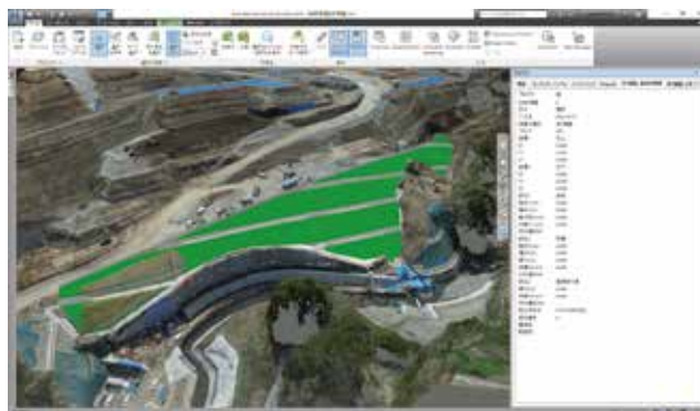
図-13 BIM/CIMモデルの維持管理展開(土工)
