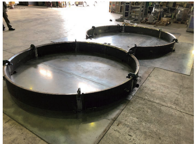
写真-7 本工事で考案した止水部材
