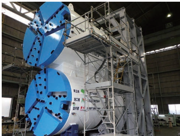
本工事のシールドマシン
